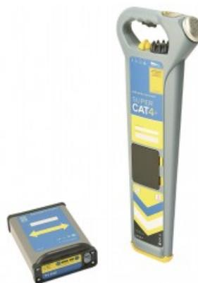
Трассопоисковая система дистанционного обнаружения подземных коммуникаций. Ищет металлические трубопроводы и кабели. Обнаруживает тональные сигналы и сигналы от зондов или систем катодной защиты.
