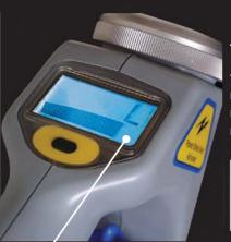
В режиме активной линии Line приемник RD2000 обнаруживает тональный сигнал, излучаемый генератором T1 в подземный проводник.
