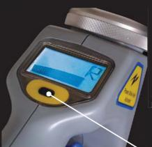
В режиме Radio приемник RD2000 обнаруживает сигналы очень низкой частоты, наведенные на подземные металлические трубопроводы и кабели радиостанциями.
