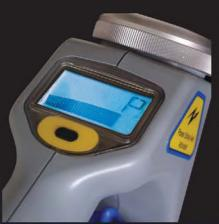
В режиме Power приемник RD2000 обнаруживает сигналы, которые излучаются нагруженными силовыми кабелями.
