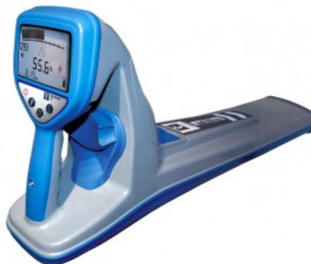
Трассоискатели RD4000 обнаруживают почти все подземные кабели и большую часть проводников, есть функция поиска маркеров. Некоторые кабели и проводники не испускают сигналы и не могут быть обнаружены приемниками Radiodetection. Прибор не показывает, исходит ли сигнал от одиночного кабеля, нескольких проложенных рядом кабелей или одного кабеля, расположенного над другим.
