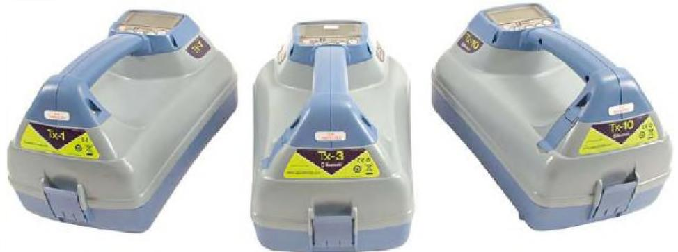
Tx-1 – простой в использовании, маломощный генератор. Tx-3 предоставляет большие возможности по току и индукции, а также имеет функцию поиска повреждения (Fault Find). Генератор Tx-10 имеет наибольшие возможности по току, а также режим поиска повреждения (Fault Find) и функцию определения направления тока (Current Direction – CD) в стандартном исполнении.
