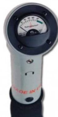
Простой в использовании и недорогой локатор неметаллических труб от компании Radiodetection. Трассоискатель пластиковых водопроводных труб находит объекты на глубине до 2 метров.
