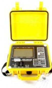
Времяимпульсный рефлектометр для тестирования кабелей типа витая пара и испытания коаксиальных кабелей.
