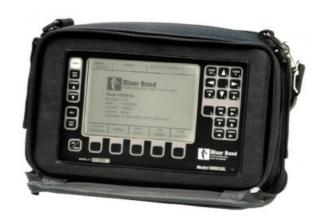
Переносной времяимпульсный рефлектометр для определения повреждений на кабелях типа витая пара в полевых условиях
