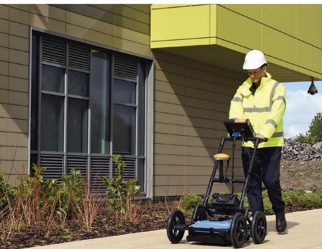
**RD1100** – инструмент, предоставляющий специалистам по геолокации, исследователям и остальным опытным пользователям возможность отслеживать и отмечать расположение любых видов кабелей и труб, в том числе из пластика и керамики. Инструмент имеет встроенную функцию создания снимков экрана, которые хранятся во внутренней памяти для мгновенной передачи данных по WI-FI или последующего экспорта на USB-накопитель. Функция GPS-навигации интегрирована в Google Earth™.
